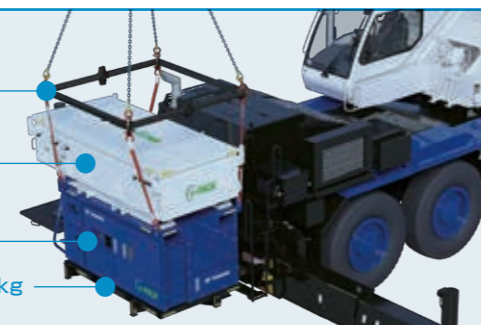
※e-PACK仕様: 車両後方に架装台、e-PACK、バッテリーを搭載。
